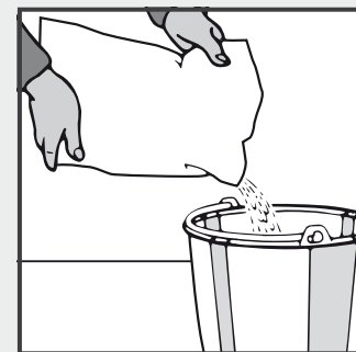
Voegengips in het water strooien
