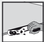
Afbeelding 4: Afwerken van het breukvlak met de schaaf
