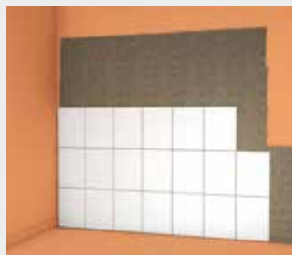
Afb. 24: Tegels worden geplaatst met een dunne laag fermacell Flexibele tegelijm op een volvlakse afdichting (garandeert de afdichting voor de vochtbelastingsklasse A).
