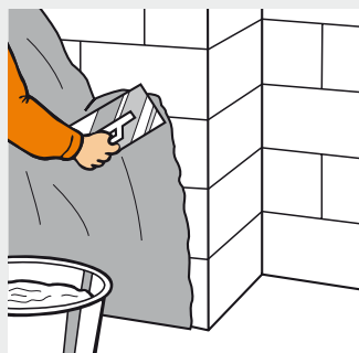
Afbeelding 7: Bij schoorsteenmuren wordt de laag gipslijm aangebracht op het metselwerk, waarop de fermacell plaat wordt vastgedrukt
